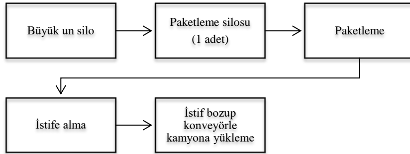
Şekil 6. Paketleme Sistemi Mevcut Süreç
